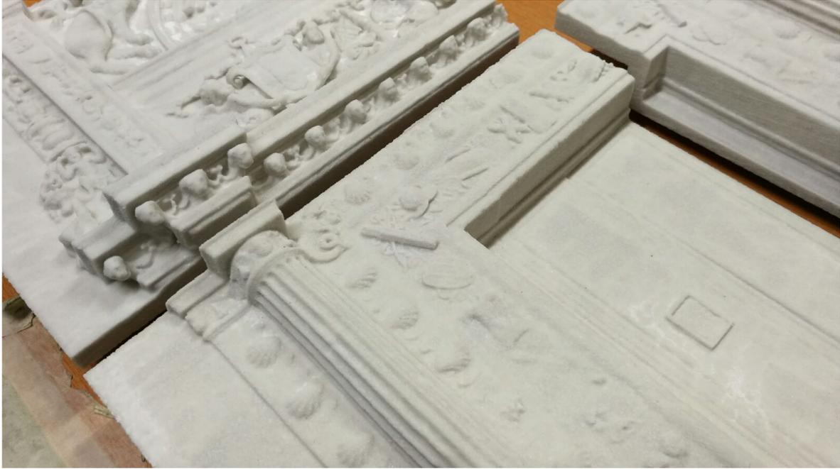
Finalmente se procederá cuidadosamente a la unión de las 8 piezas con el mismo composite, cuando este ensamblado, se aplica un material de imprimación y después un acabado color para otorgarle un acabado homogéneo.
